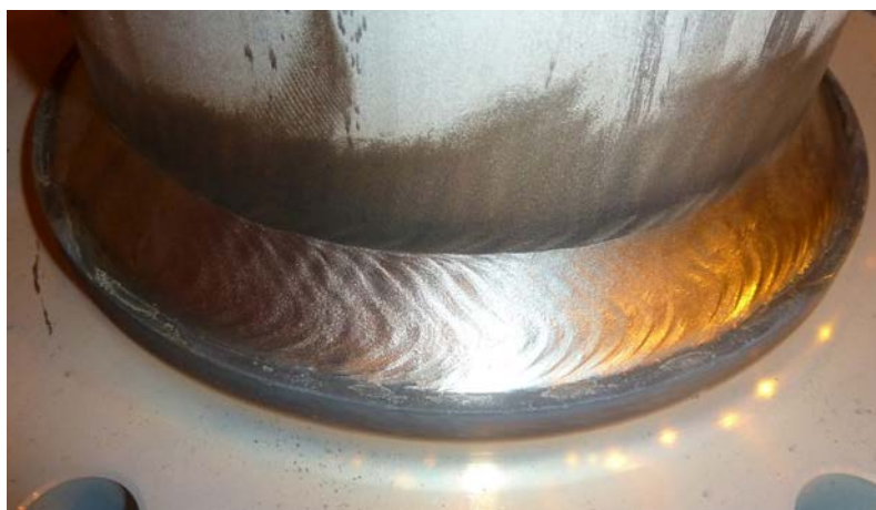
Soldadura en ángulo en posición plana (PB/2F). El metal base es AISI 304L y el metal de aportación es FOXcore 308L-T0 DG Ø 1,2 mm.
