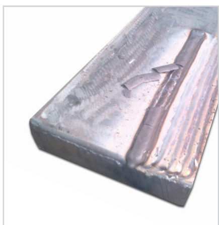
Primera capa de plaqueado con FOXcore 309L H-T0 con buen desprendimiento de la escoria.
