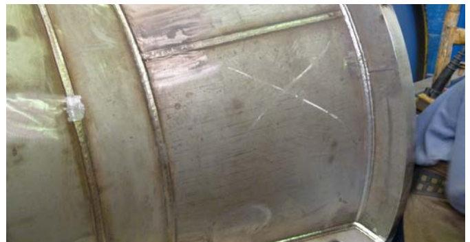
Bomba de agua de mar de acero inoxidable dúplex 1.4462 soldada con FOXcore 2594-T1 para la mayor resistencia a la corrosión posible.
