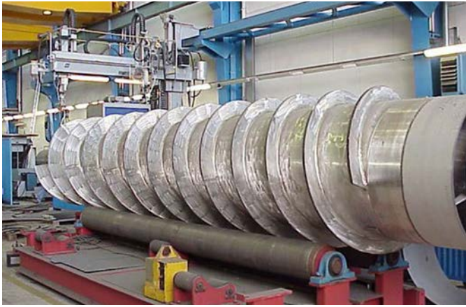
Eje sin fin para la industria de la pulpa y el papel fabricado con AISI 316Ti y soldado con \varnothing 1,2 mm FOXcore 316L-T0. Cortesía de Andritz AG, Austria.
