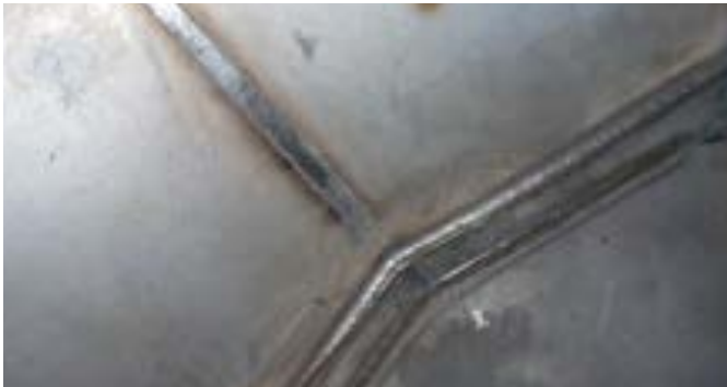
Soldeo de 1.4462 en posición vertical ascendente y bajo techo utilizando FOXcore 2209-T1.
