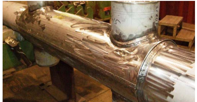
Elevadores de inyección de agua en fundas PUG. Superdúplex soldado con FOXcore 2594-T1 HD.
