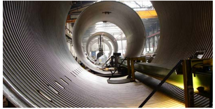
Soldeo de serpentines de Ø 1,2 mm utilizando FOXcore 316L-MC. Cortesía de Neuman Anlagentechnik, Alemania
